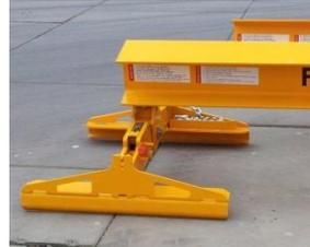
2. Platzieren Sie die Traverse (.mit geöffneten Klemmbacken) OBERHALB des SCHWERPUNKTES (mittig) der Spannbeton-Hohlplatte und setzen sie diese vorsichtig auf dem Deckenelement ab. Achten Sie darauf, dass die Klemmbacken nicht über das Deckenelement hinausragen oder im Bereich von Aussparungen angesetzt werden.
